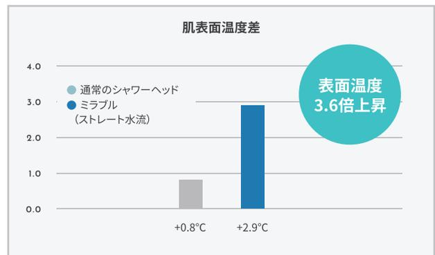
条件=水温:37°C/室温:20°C/吐出面より測定対象を30cm離して水流を30秒あてた後、肌の表面温度を測定。12名の被験者において一般的なシャワーヘッドより、平均値3.6倍の温度上昇という結果。
