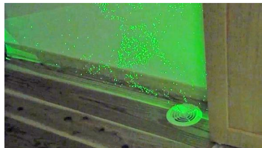
床下換気システムが花粉を吸引する様子
